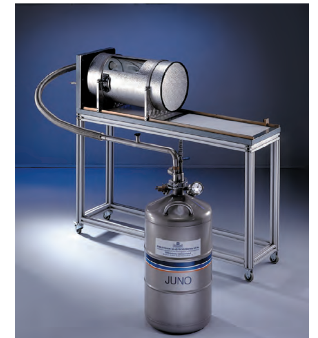
KALTGAS-System Typ TGK-40/50 für einen Temperaturbereich von +80^{\circ}\text{C} bis -160^{\circ}\text{C} , mit einer Temperaturstabilität bis \pm 0,2^{\circ}\text{C} . Die Kammer besitzt ein großes Sichtfenster.
