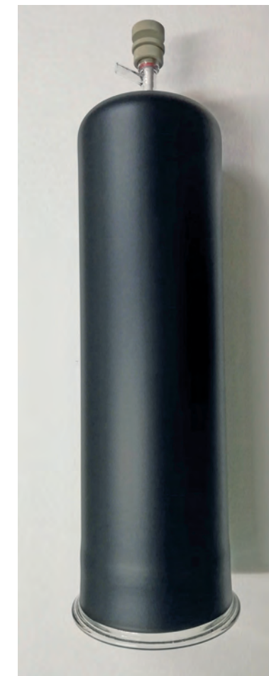
Reaktor und Deckel mit UV undurchlässiger Sicherheitsbeschichtung Reactor and lid with an UV blocking safety layer
