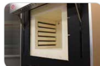
Topné spirály v drážkách vyzdívky
