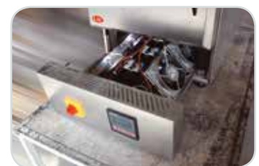
Zásuvka s elektro prvky pece pro snadný servis
